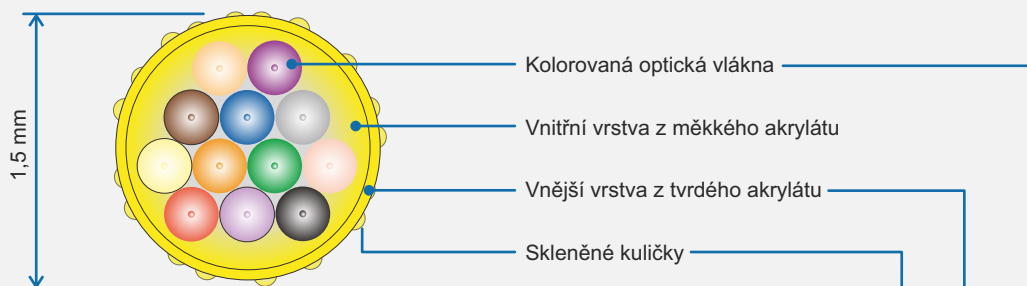
Řez kabelem (zobrazena 12vláknová jednotka)
